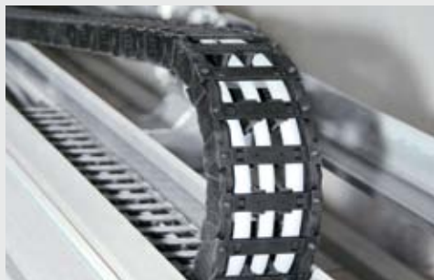
Stromzufuhr zur Kabine mittels Energiekette
